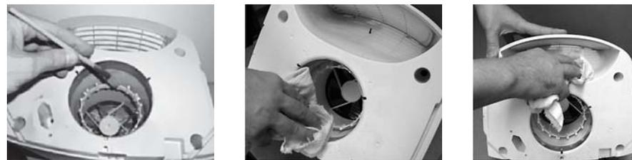
Протрите корпус устройства тканью слегка смоченной в воде с моющим средством (не содержащих абразивов), затем протрите его насухо и обязательно просушите. Не допускайте попадания воды внутрь панели управления и крышки устройства.
