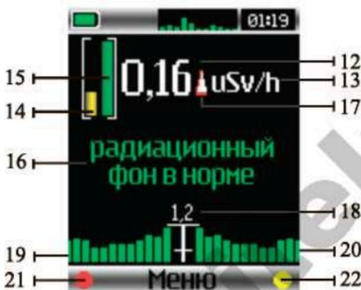
12. Уровень радиоактивности. Отображается крупными цифрами в центре экрана. При первом измерении отображается слово «ИЗМЕРЕНИЕ».
