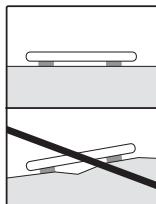
Установить весы на прочную ровную поверхность.
