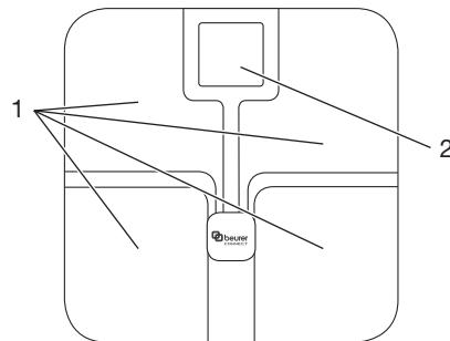
\*ITO (roztwór stały tlenku iudu i tlenku cyny): Ta innowacyjna, przewodząca ładunki elektryczne powłoka spełnia funkcję elektrody do pomiarów ciała.
