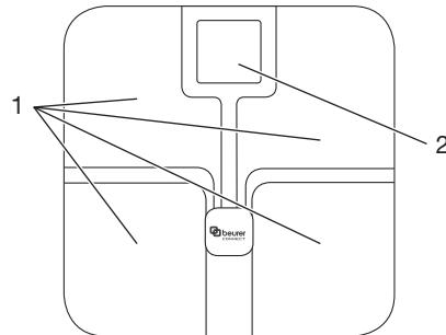
\*ITO (Indium tin oxide): questo innovativo rivestimento conduttore viene utilizzato come elettrodo per la misurazione del corpo.
